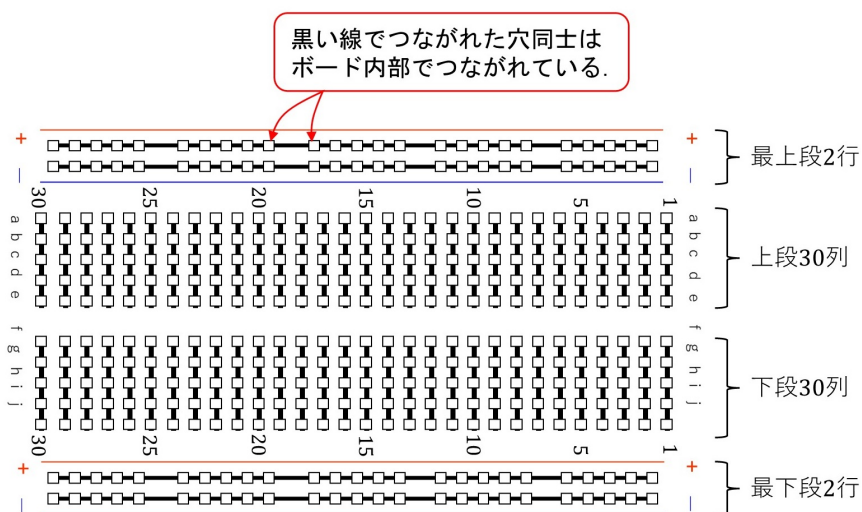
図 22: ブレッドボードの内部配線
