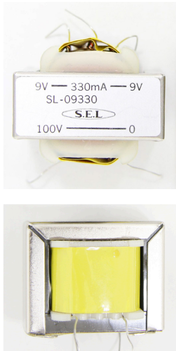
図12.1 変圧器(トランス)の例 一次側:100V 二次側:9V-0-9V
