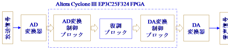
図 15.18: ストレート方式ソフトウェアラジオ（バンドパスフィルタ無し）のブロック図
