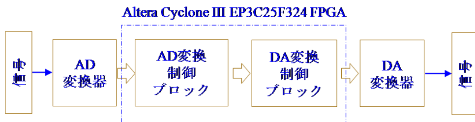
図 15.8: AD-DA 変換テスト装置のブロック図
