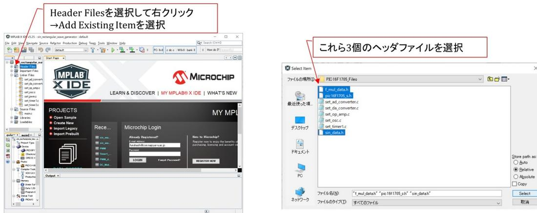
図 4.8: MPLAB® X IDE: Header files の追加
