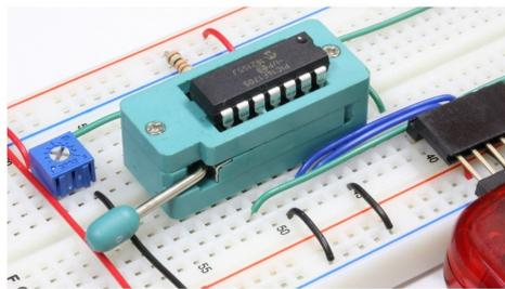
図 3.10: ゼロプレッシャーソケット使用によるマイコン挿抜の容易化 (その2)
