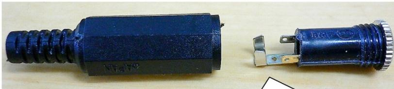
短い電極が2個（左右チャンネル）と長い電極が1個（GND）があります。
